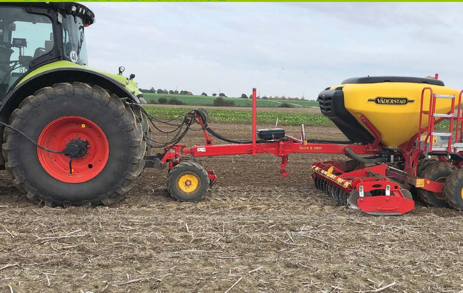
Die pneumatische Drillmaschine Väderstad Spirit R 300 S vereint eine gute Ablagegenauigkeit mit hoher Schlagkraft.
